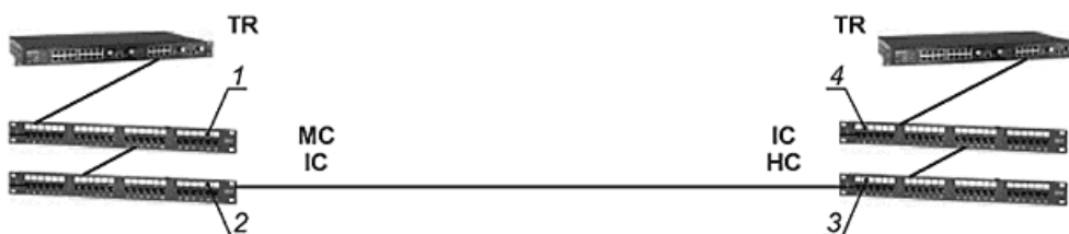
Рисунок 28 - Модель канала магистральной кабельной подсистемы с четырьмя точками коммутации
